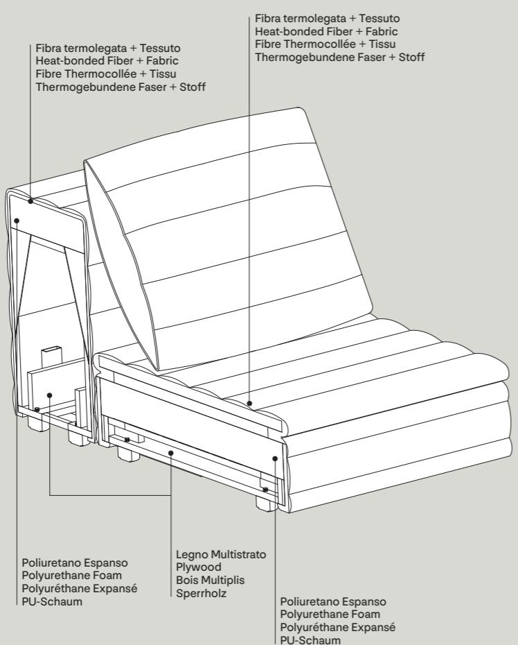
Struttura / Structure / Structure / Gestell
